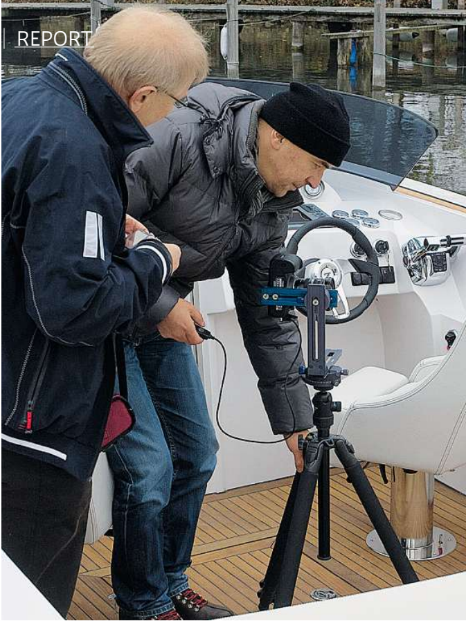
Die Skalierung am Schwenkkopf erlaubt die präzise schrittweise Ausrichtung der Kamera, der Fernauslöser verhindert Verwackeln
